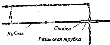
Рис. 4.11 Пересечение кабелем 1х2 проводов электроосвещения.
